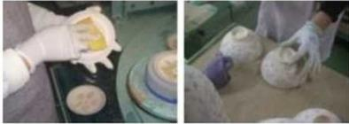
印刷サイクルタイム内での印刷後製品検査
