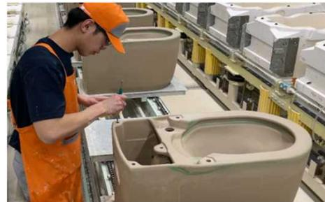
主に成形作業（成形機の金型取付作業、成形機の調整及び成形作業、成形品の検査作業等）と検査作業（焼成品における検査作業、不良率の算出作業等）。
