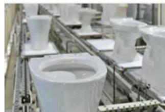
ローラーコンベアーによる重筋作業回避
