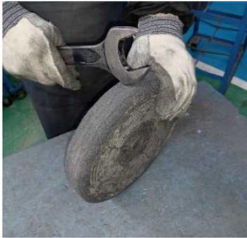
○クラッキングと呼ばれる作業で、バフの表面を固いもので全体的に叩いて、バフに弾力を持たせる。その後、ならしを行いバフ作業に入る。
